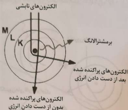
شکل ۴-۵: تولید اشعه X به روش عمومی (برمشترا لانگ)
